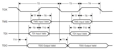
Figure 4-11. JTAG Timing Diagram
