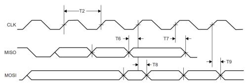
Figure 4-6. SPI Slave Timing Diagram
