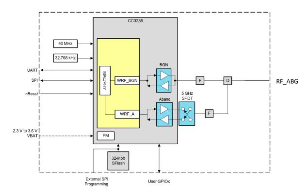
Figure 2-1. BDE-WF3235 Module Block Diagram
